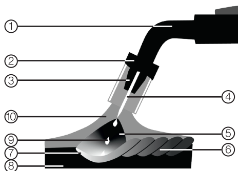
Рис. 24. Полуавтоматическая сварка MIG/MAG.
